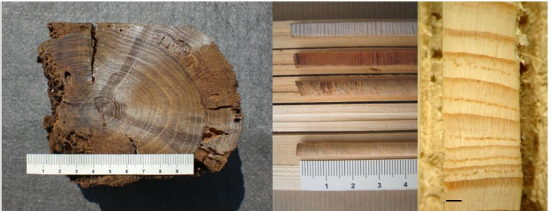
präpariertes Kappstück, Probenmontage und Lupenbild eines auf einem Träger fixierten Bohrkerns<sup>11</sup> (Fichte); Maßbalken  $\cong$  1 mm
