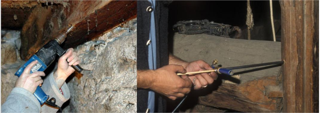
Probenentnahme mittels Fräsbohrer bzw. Bergung eines Bohrkerns (Hohlbohrer)
