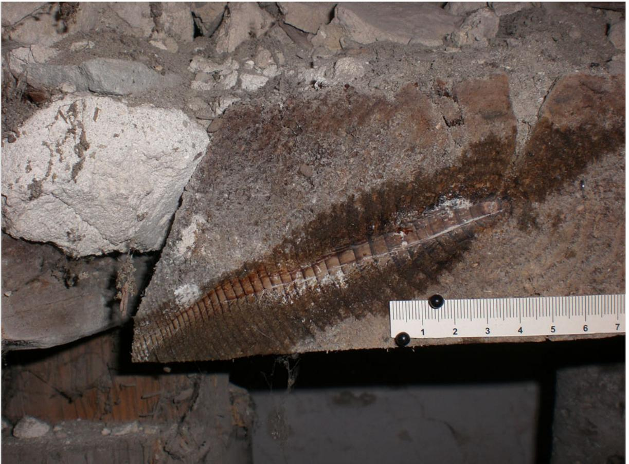
Bildausschnitt eines präparierten, mit Wasser benetzten und Kreidestaub kontrastierten Proberadius an der gesägten Querschnittsfläche einer Deckenbohle
